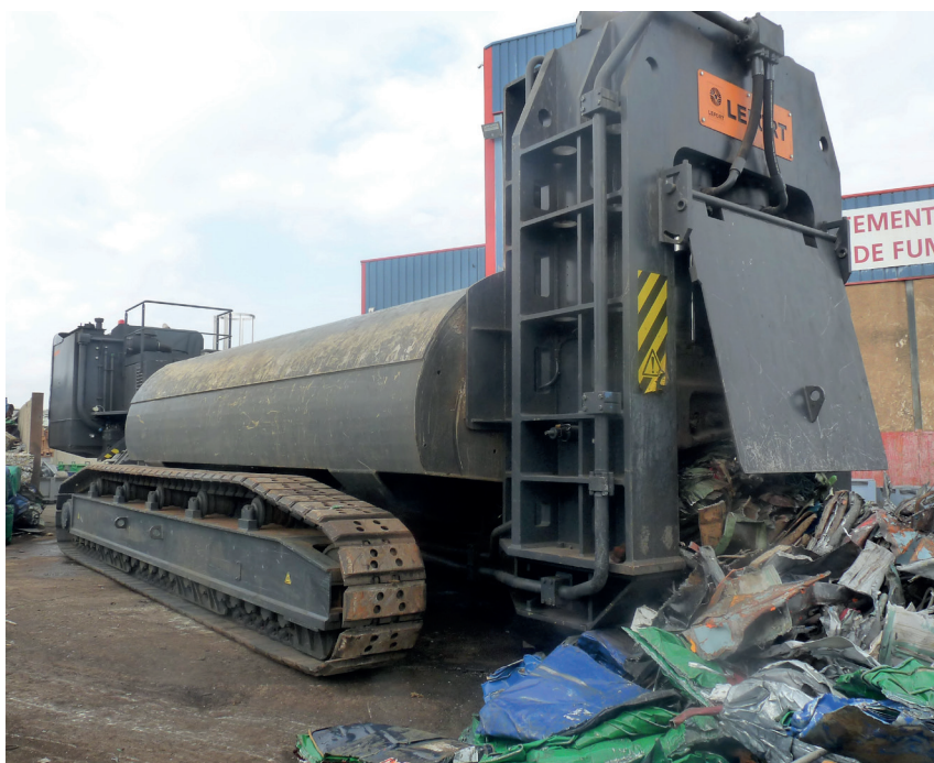
La presse-cisaille peut traiter les différentes typologies de ferrailles.
