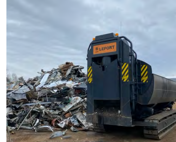
TRAX650 de Peacock's Recycling : Caisse de 6m, pousseur de 180 tonnes, deux volets de 240 tonnes chacun et moteur diesel de 302 CV.
