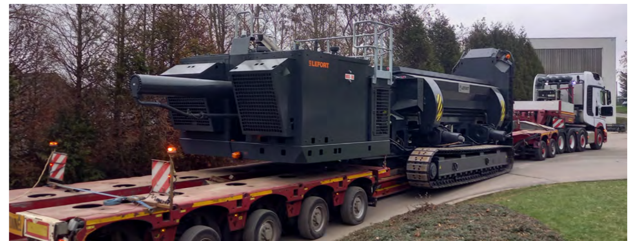
Presse cisaille TRAX 700 de Bader Recycling : Force de coupe de 700t, bac de 6600x2600 mm, écraseur de 120t, pousseur de 180t, force sur chaque plateau de 325t, motorisation diesel de 400hp.
