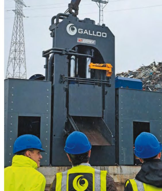
Nouvelle LIDEX chez GALLOO : force de coupe de 2 000 tonnes, grande largeur de lame de 1500 mm, caisse de 10 mètres et hydraulique puissante de 8x110 kW
