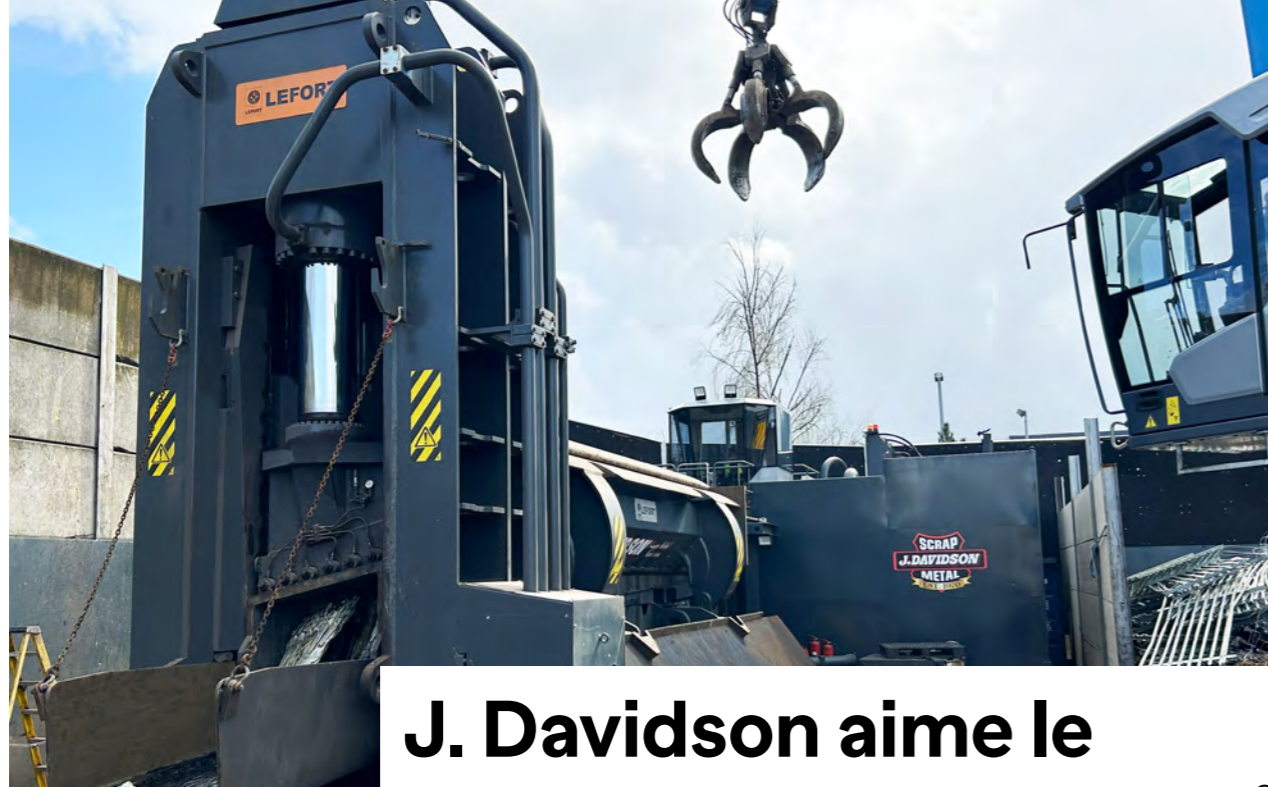
KOLOSS de J. Davidson : Force de coupe de 1300t, caisse de 8m, deux volets de 400t chacun, écreuseur de 240t et pousseur de 180t.
