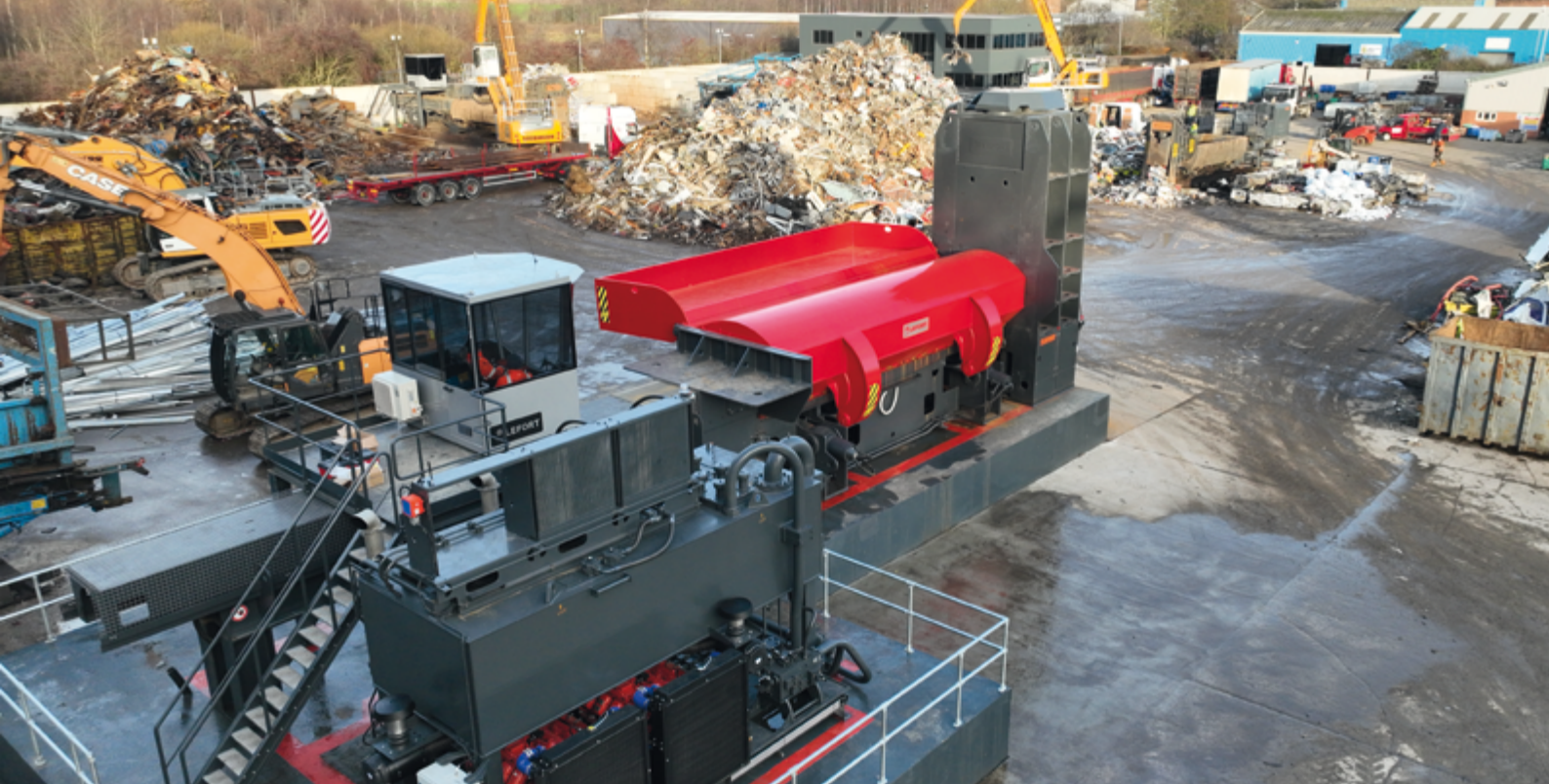
La KOLOSS 1450 : 1 450 tonnes de force de coupe, motorisation diesel V8 Scania puissante, caisse de 8 mètres et benne de chargement.
