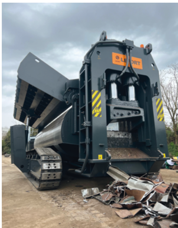
La TRAX, un des produits phares de LEFORT® associe mobilité et productivité, offrant aux opérateurs une plus grande flexibilité dans leurs opérations quotidiennes. Ici une version en 1 250 tonnes de force de coupe (1 375 US) avec benne de chargement, installée chez OmniSource, LLC (Indiana).
